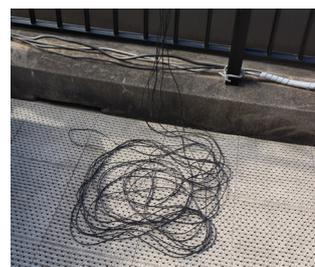
ラジアルはきれいに張るより、ごちゃっとまとめた方が SWR が下がりがやすくなります。さらに 1 セット追加してラジアルの本数を増やしたり、アンテナの設置が高く床にラジアルの設置面積が少ない場合はラジアルの長さを追加することで、SWR の特性がよくなる場合があります。
