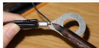
6. ラグ端子部分を収縮チューブをかぶせ、ドライヤーまたはヒートガンでチューブを収縮します。はんだごてで収縮する場合は電線のビニール絶縁を溶かさないように注意してください。
