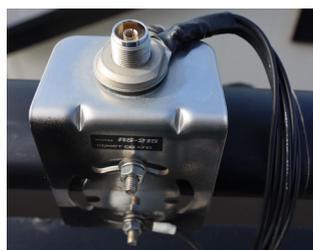
ベランダフェンスにパイプ取り付け基台を設置し、ラジアルを取り付けた例です。
