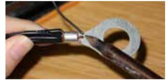
6. ラグ端子のはんだ付けした端子部分を収縮チューブをかぶせ、はんだごてでチューブを収縮します。
