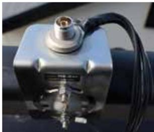
パイプ取り付け基台「RS-215」にラジアルを取り付けた例です。
