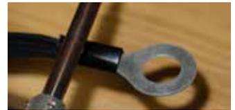
7. 電線の先端を自己融着テープを巻き、水が入らないよう防水加工をしておきます。
