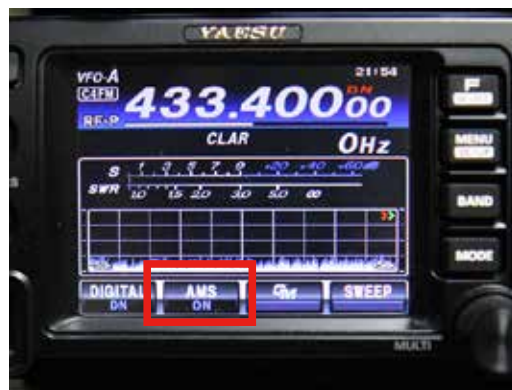
写真3. FT-991 シリーズの AMS キー ディスプレイの AMS と表示されている部分を タップすると AMS 機能の ON/OFF ができる
