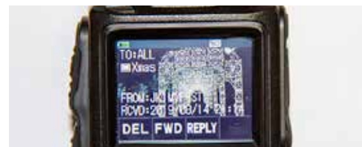
写真2. FT3D で画像を受信して表示した様子 受信した画像は microSD カードに保存される
