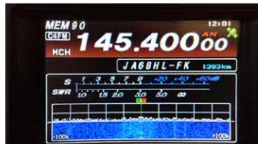
写真1. C4FM で交信中のトランシーバディスプレイにコールサインと通信距離がリアルタイムに表示する
