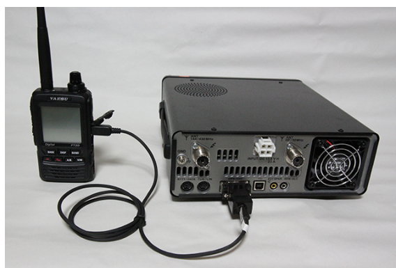
写真 2-1 : FT2D と FT-991 を CT-169 で接続
